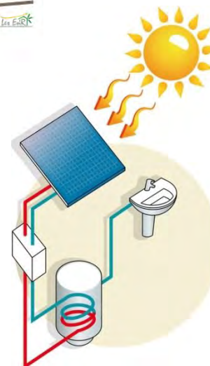
Production d'eau chaude solaire
