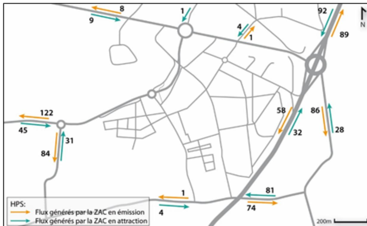
Figure 134 : Répartition des flux générés par le projet, logements et activités, en HPS, SARECO 2015.
